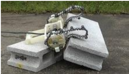
SMURF mit einrädiger, flexibler Schiene beim Klettern auf Geröll ©CURSOR
