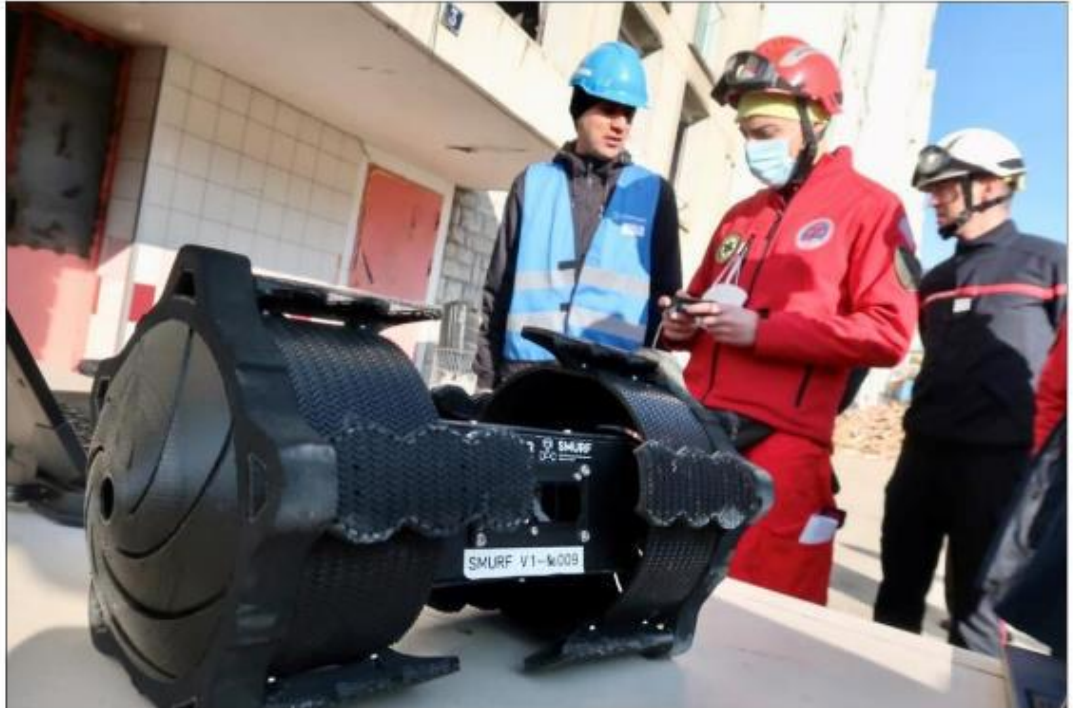
Le robot Smurf est équipé de neuf capteurs lui permettant de retrouver des victimes sous des décombres. Le DL/P.-E. B.
